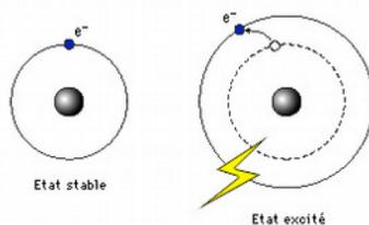
Lorsqu'un atome est excité par un apport extérieur d'énergie, de la chaleur par exemple, les électrons passent sur des niveaux d'énergie supérieurs.
