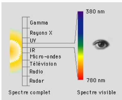
La lumière visible ne représente qu'une partie du spectre du rayonnement électromagnétique solaire selon le schéma ci-contre.
