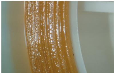
Macrophotographie d'un rouleau de ruban autocollant. La colle a migré depuis la surface de l'autocollant vers les bords. De même, la colle migre dans le papier sur lequel l'adhésif a été apposé. A terme, l'autocollant cesse d'adhérer et il ne reste que la colle, souvent oxydée et de couleur brunâtre dans le papier du document. Cliché A. Giovannini.
