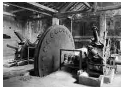
Image 27 Défibreur à presse mis au point par le Français Aristide Bergès
