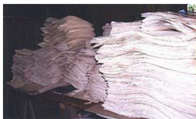
Image 21 Papier avant le passage dans la calandre (laminage), au moulin de Larroque (France, Dordogne)
