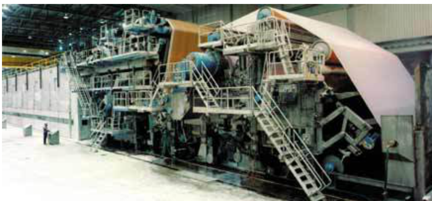
Image 33 Machine de l'usine Kruger (Trois-Rivières, Québec). Cette machine produit 205 000 tonnes de papier journal par an.
