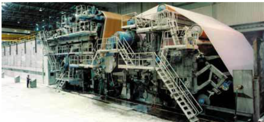
Image 20 Machine de l'usine Kruger (Trois-Rivières, Québec). Cette machine produit 205 000 tonnes de papier journal par an.
