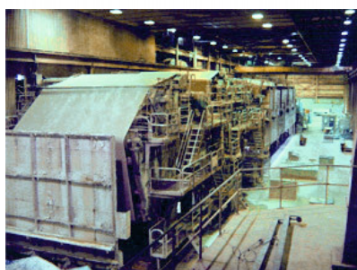
Image 30 Machine à papier de l'usine Kruger Wayagamack (Trois-Rivières, Québec) : partie humide
