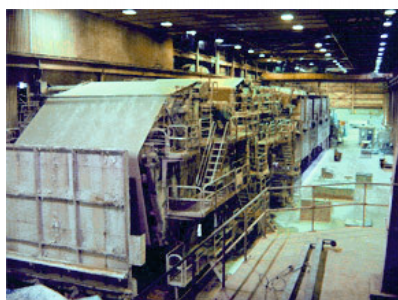
Image 17 Machine à papier de l'usine Kruger Wayagamack (Trois-Rivières, Québec) : partie humide
