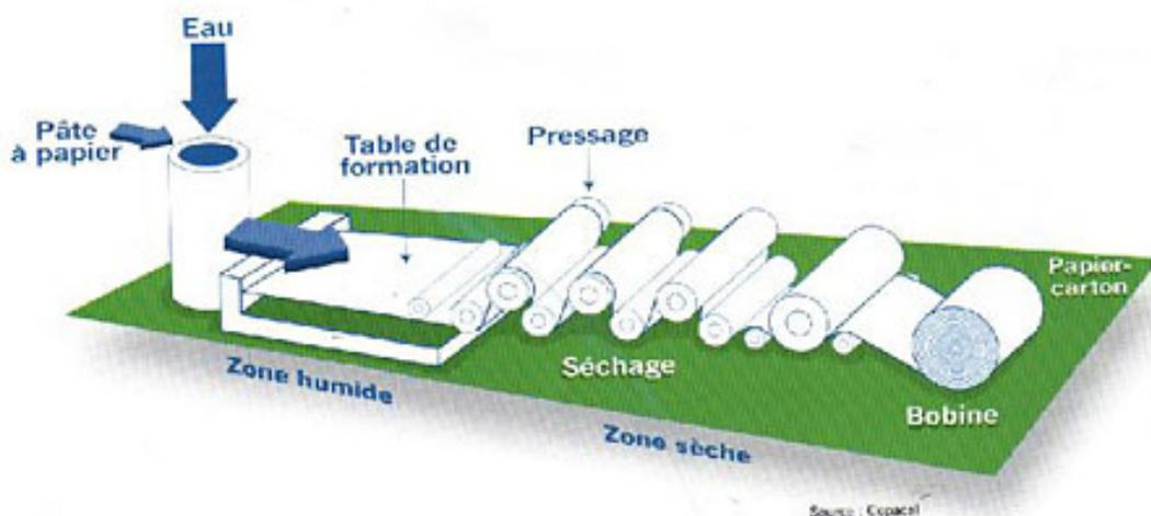
Image 5 Schéma d'une machine à papier
