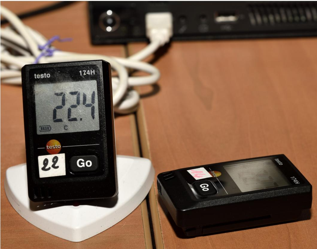
*Sondes électroniques autonomes enregistrant un relevé thermo-hygrométrique jusqu'à une période d'un an, que l'on peut afficher et imprimer sous forme de graphique via un socle de connexion à un ordinateur et une application dédiée.*
