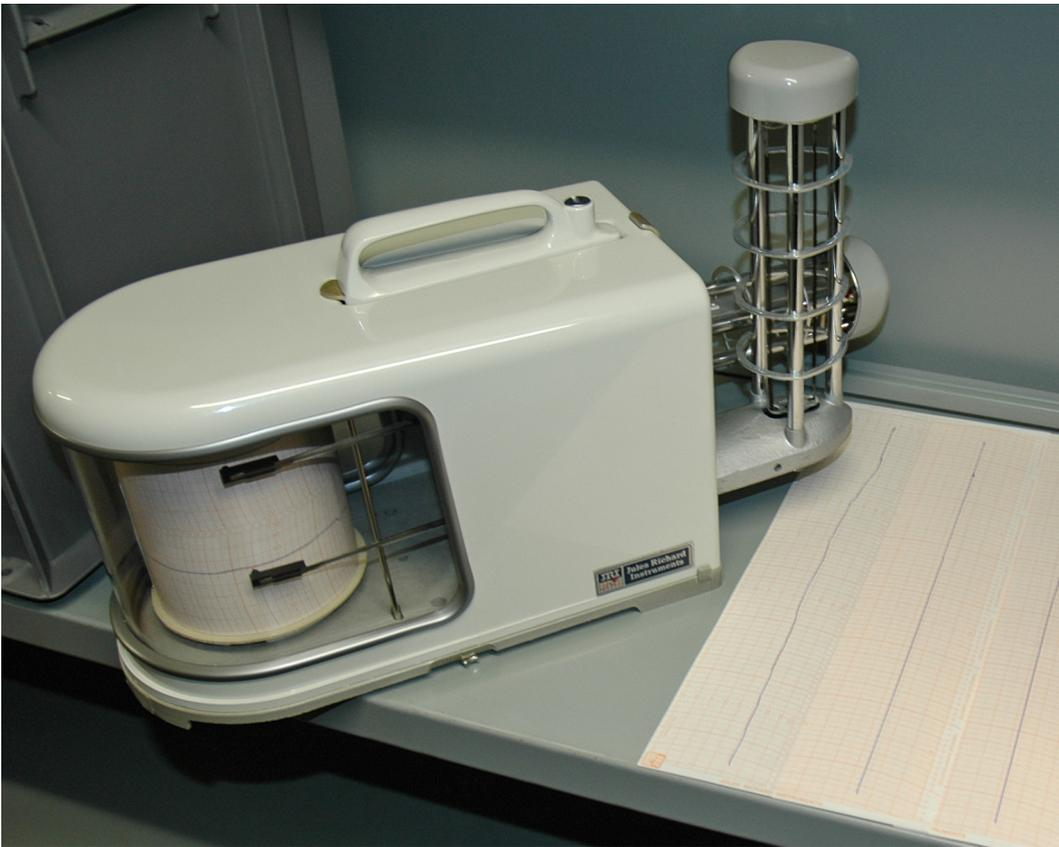
*Thermo-hygromètre classique (à cheveu) mesurant à la fois les températures et l'hygrométrie dans les magasins de conservation.*
