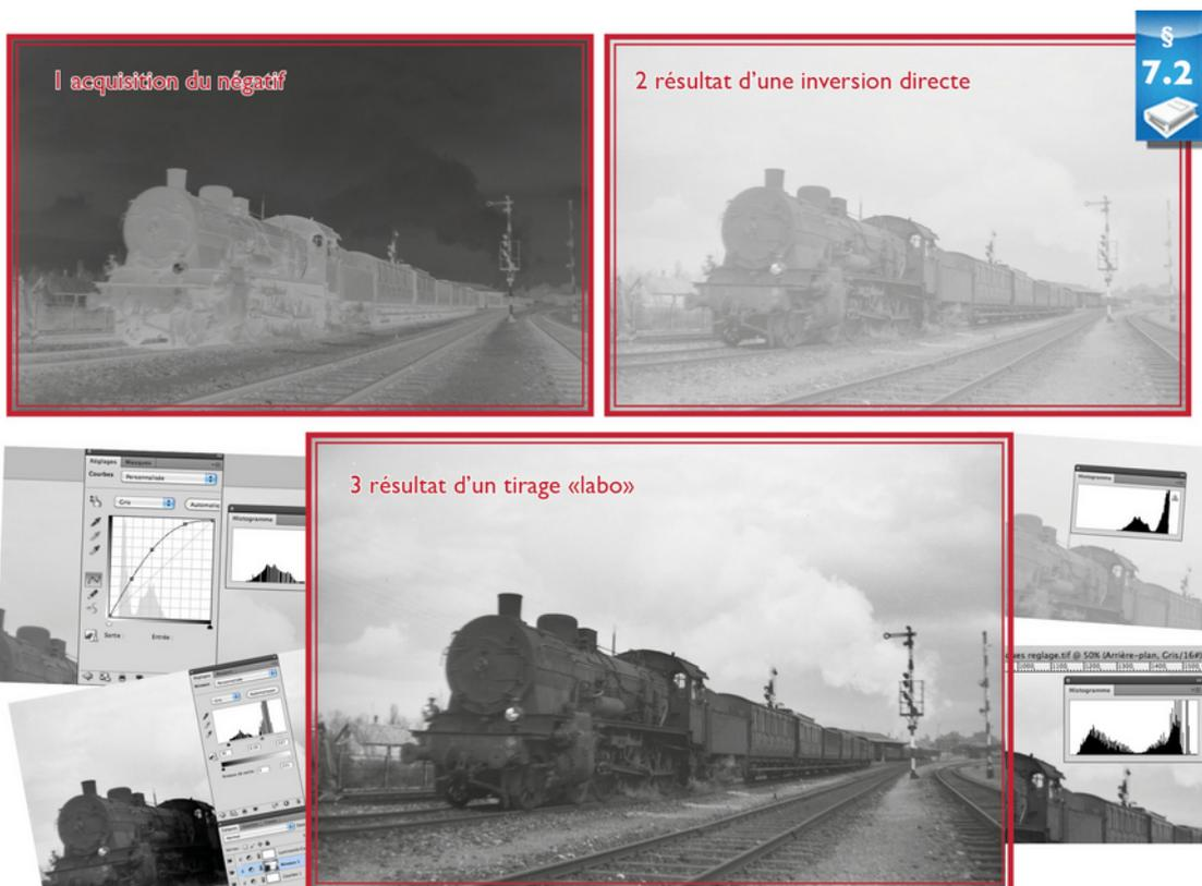
Cet exemple montre les trois étapes de la numérisation d'un négatif. Le négatif original est acquis en 16 bits niveaux de gris (1), l'inversion directe(2) montre une image plate. Le post-traitement (3) consiste à refaire le travail du tireur au laboratoire: restituer l'image dans une gamme de tons complets du noir profond au blanc pur. Ensuite l'image est conservée en 8 bits soit 256 niveaux de gris. (Photo Jean Serain)
