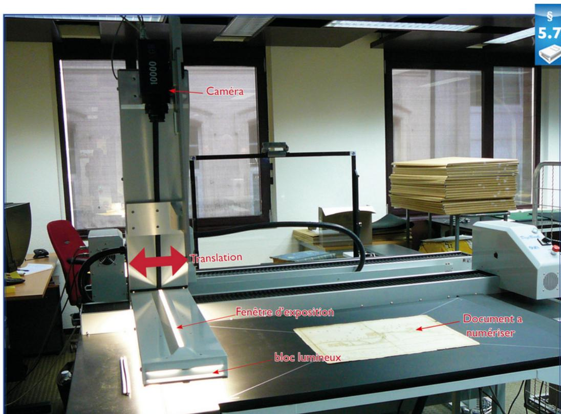
Numérisation d'un plan sur un numériseur de grand format «suprascan» à caméra dynamique. Le bloc lumineux est placé à proximité de l'original pour un éclairage symétrique sans effet d'ombre. La caméra équipée d'un capteur linéaire scrute le document à travers la fenêtre d'exposition. L'ensemble du bâti caméra et source de lumière se déplace de gauche à droite pour balayer tout le document (Aux Archives de l'Etat en Belgique - Bruxelles photo P.Perrot)
