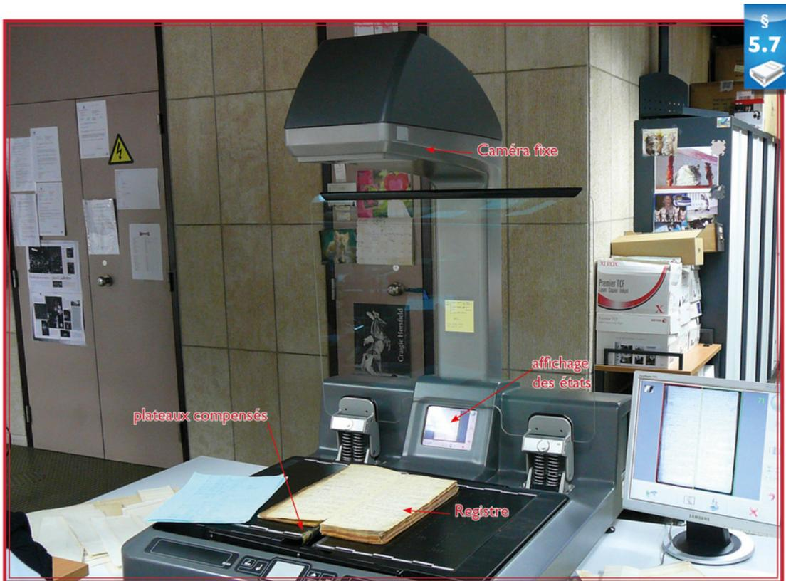
Exemple de poste de travail sur un numériseur de grand format. Le registre est placé sur les plateaux compensés. On peut rabattre la vitre d'exposition pour obtenir une meilleure planéité de l'original s'il n'est pas fragile. Sur le moniteur à droite, le document numérisé. Un petit écran au pied de la colonne renseigne l'opérateur sur le nombre de vues et les modes de fonctionnement sélectionnés. (Aux Archives de l'Etat en Belgique - Bruxelles photo P. Perrot)
