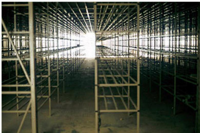
*Image 1 Certains services disposent de locaux dits de préarchivage pour les documents à durée de conservation limitée : dans ce cas on admet du matériel de stockage de type industriel très économique et qui convient pour des cartons d'archives normalisés (type Dimab par exemple).*
