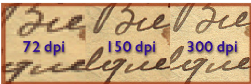
Image 3 Aspects des résolutions 72, 150, 300 dpi pour un document à tons continus (agrandissement 4x).
