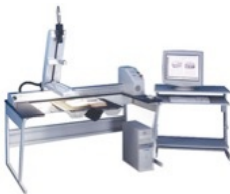
Numériseur à caméra dynamique et la station d'acquisition
