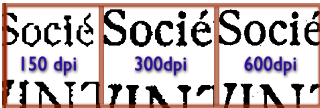
Image 2 Aspects des résolutions 150, 300, 600 dpi pour un document bitonal (agrandissement 4x).
